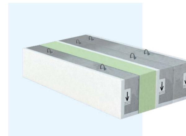
^ Spur Detail Tragende Stürze bei einer Wanddicke von 500 mm.
