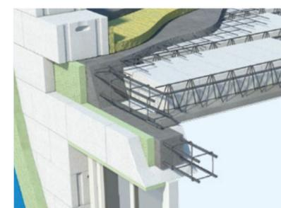
Sturzes mit einer Breite von 375 mm aus den U-Schalen mit Wärmedämmung mit einer Wanddicke von 80 mm
